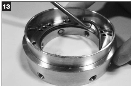
13 Rimuovere l'O-ring dell'anello di blocco (Y) ed eliminarlo.
