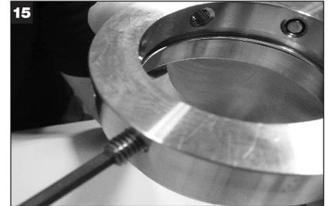
**IMPORTANTE:** Le viti di fermo non devono sporgere nel diametro interno dell'anello di blocco prima dell'installazione nella bussola della tenuta.
