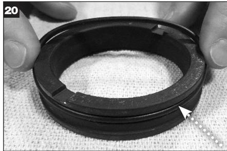
Applicare un sottile strato di grasso all'O-ring della faccia rotante (V) e installarlo nella scanalatura sul diametro esterno dell'anello di tenuta della faccia rotante esterna
