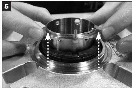
Rimuovere la bussola. Rimuovere il tubo di azionamento ed eliminarlo. Mettere da parte la bussola.
