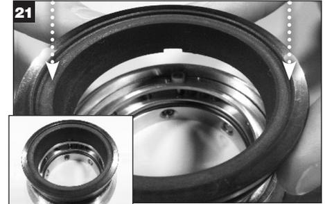
Allineare le scanalature nell'anello di tenuta della faccia rotante con le guide della bussola; premere delicatamente sull'anello di tenuta della faccia rotante per posizionarlo nell'anello di blocco. **ATTENZIONE: Non comprimere il tubo di azionamento.**
