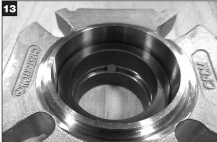
Allineare le scanalature nel rimanente anello di tenuta della faccia stazionaria con i fermagli del condotto anti-rotazione e il deflettore di flusso e premere delicatamente in posizione. Accertarsi che l'anello di tenuta sia ben posizionato.
