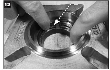
Capovolgere con attenzione la flangia e posizionarla su un panno pulito per proteggere la superficie di tenuta interna. Applicare uno strato sottile di grasso al rimanente O-ring della faccia stazionaria e inserirlo nella scanalatura nel diametro interno della flangia.
