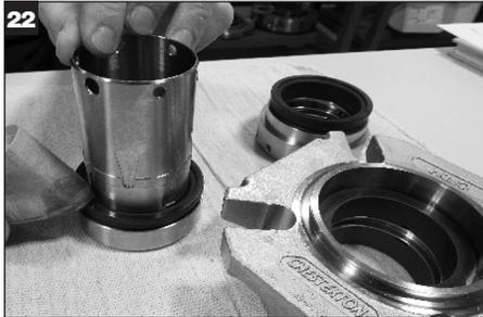
Pulire tutte le superfici della tenuta con un panno pulito e un solvente approvato prima del montaggio finale dei componenti.
