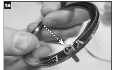
Prendere il tubo di azionamento (utilizzando le pinzette se necessario) e installarlo su ognuna delle guide nella bussola. Accertarsi che il tubo di azionamento sia ben posizionato sulle guide.
