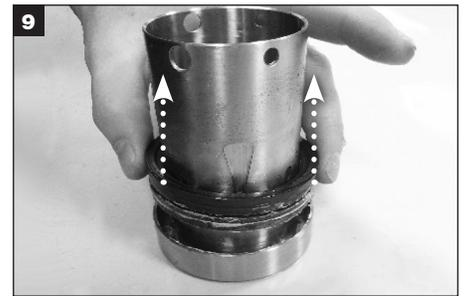
Rimuovere l'anello di tenuta della faccia rotante interna dalla bussola ed eliminarlo.
