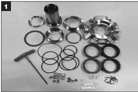
Utensili necessari per il montaggio della tenuta: Chiave a brugola e due tipi di grasso (forniti con la tenuta); panno senza filacce, pinzette o punteruolo (forniti dal cliente; per l'installazione degli O-ring e del tubo di azionamento). Pulire con un solvente approvato tutti i componenti metallici, anche tutte le guarnizioni e le superfici degli O-ring. Posizionare i componenti metallici e tutte le parti di ricambio della tenuta su una superficie pulita e asciutta.
